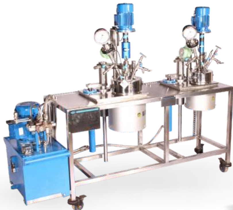
1 ltr & 5 ltr autoclaves for corrosion testing
